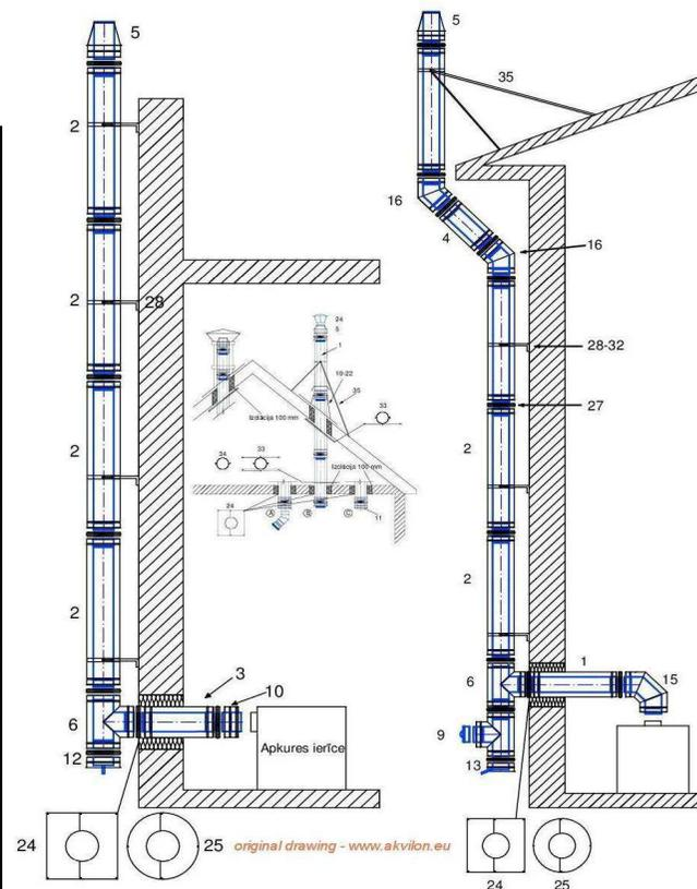
Изолированная система дымохода из нержавеющей стали состоит из внутренней трубы (нержавеющая сталь 0.6мм), термо устойчивого 50мм толщины слоя изоляции и несущей внешней оболочки. CE сертификат.
