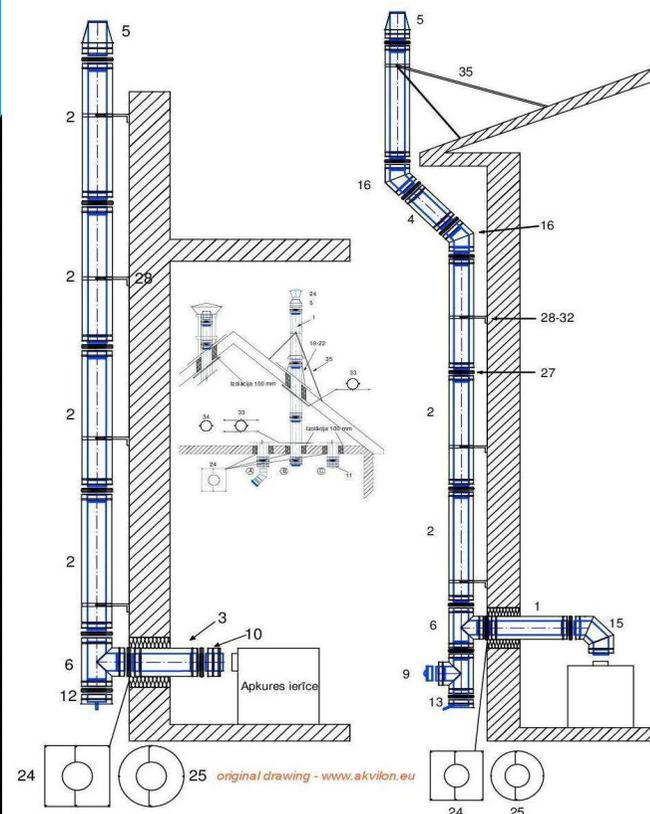
Изолированная система дымохода из нержавеющей стали состоит из внутренней трубы (нержавеющая сталь 0.6мм), термо устойчивого 50мм толщины слоя изоляции и несущей внешней оболочки. CE сертификат. Оболочки: N304 - нерж. сталь 304 марки N430 - нерж. сталь 430 марки PE - крашенный металл с полимерным покрытием PE ZN - оцинкованный металл
